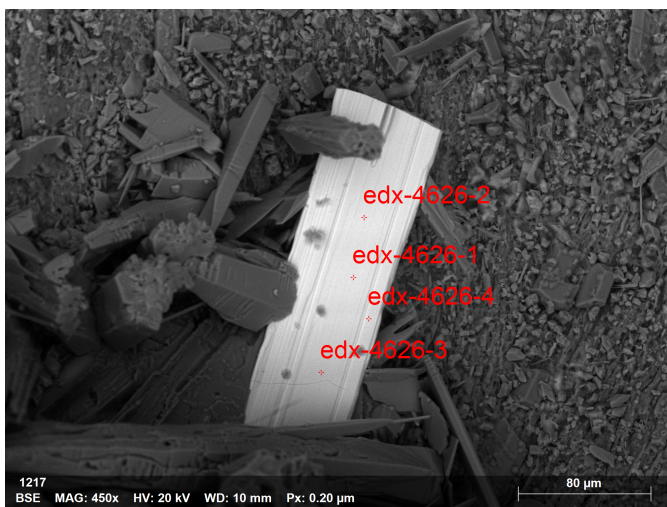
Abbildung 10: Messpunkt und EDX-Ergebnistabelle
